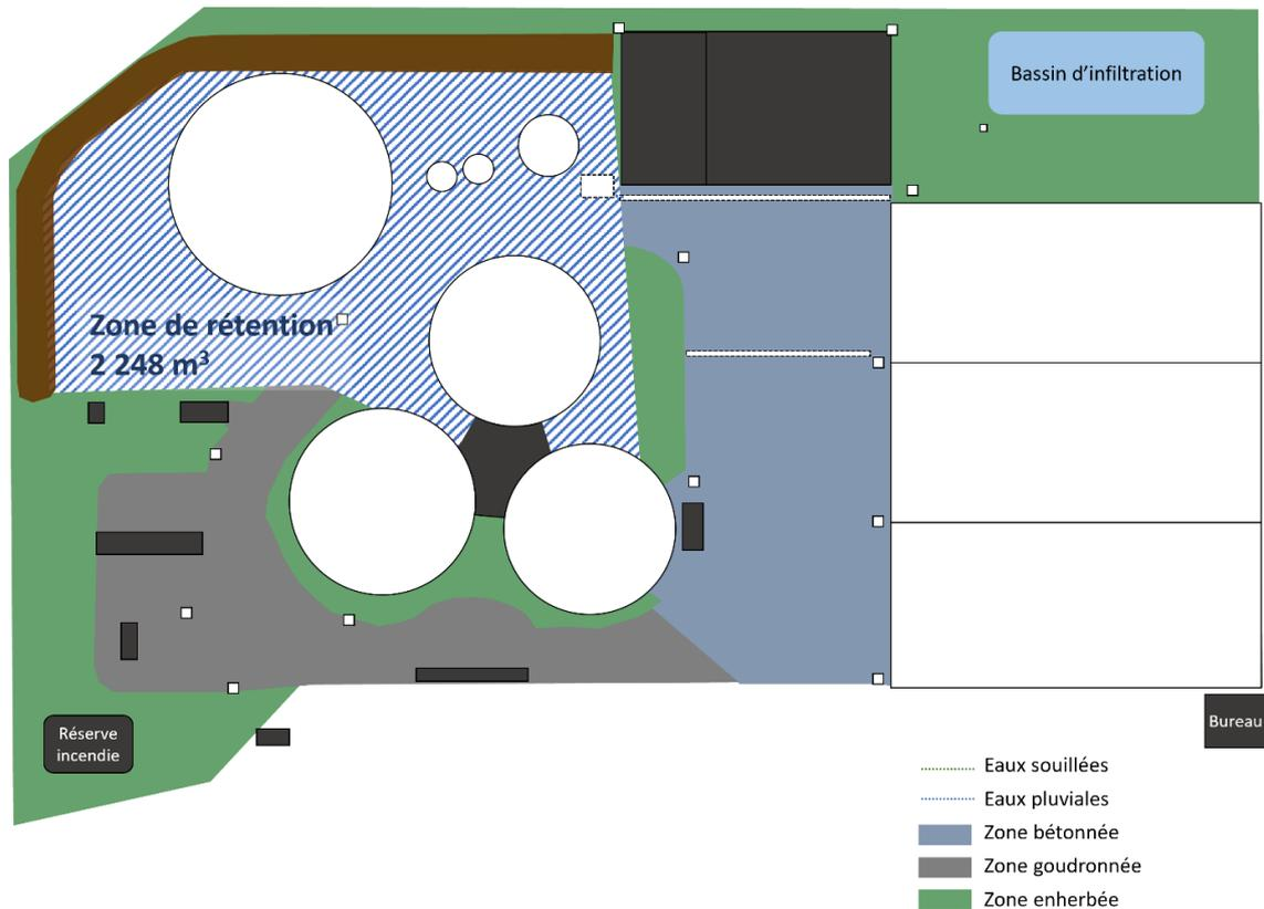
Figure 4: Zone de rétention du digestat, en cas de fuite
